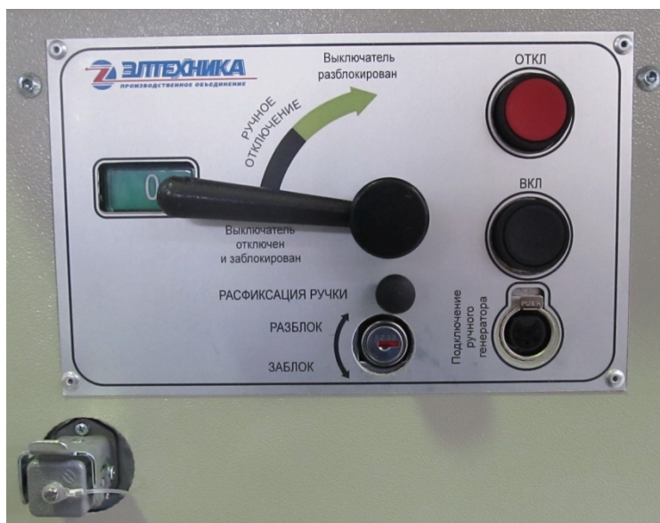
Рис.6в Рукоятка отключения заблокирована.
