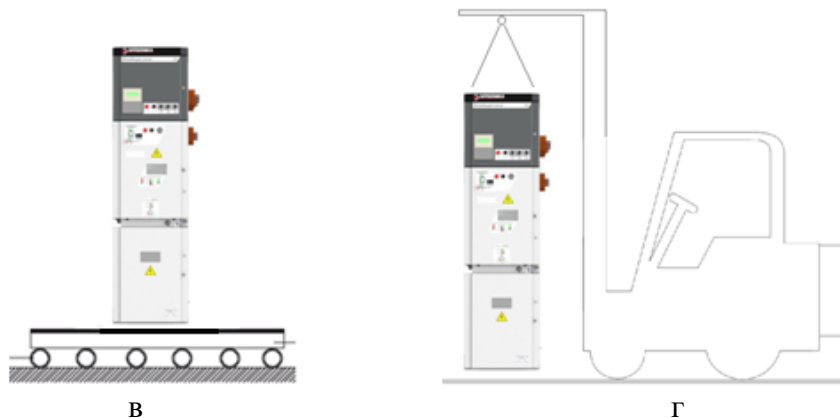
Рис. 16. Способы перемещения шкафов КРУ на транспортном поддоне
