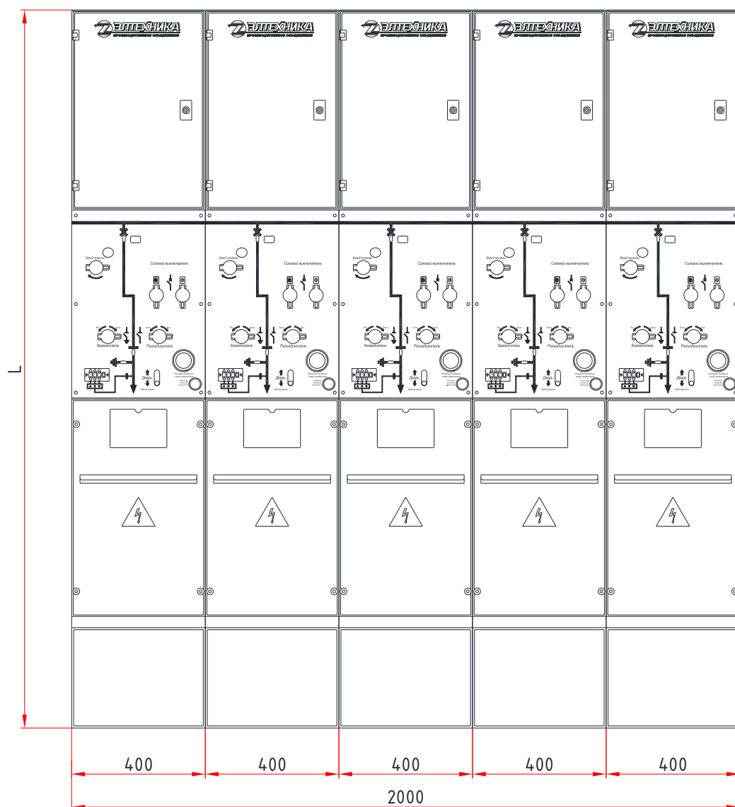
Рис. 2.2 Габаритные размеры максимальной секции шкафов КРУ базовой конструкции на номинальный ток 630А.
